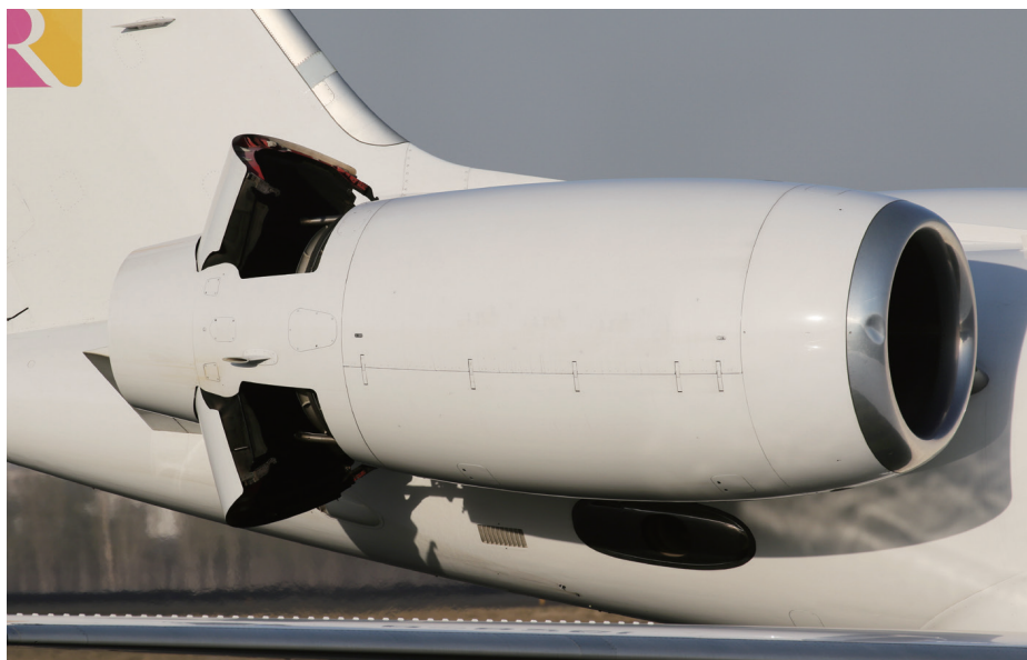
飞机在降落过程中打开反推装置（摄影：魏萌）
