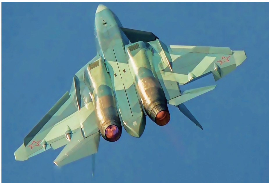
苏-57第一阶段动力AL-41F-1具备推力矢量控制能力
