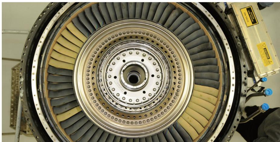
图6 安装CMC叶片的F414验证发动机
