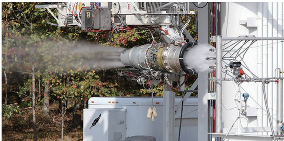
航空发动机吸鸟试验
