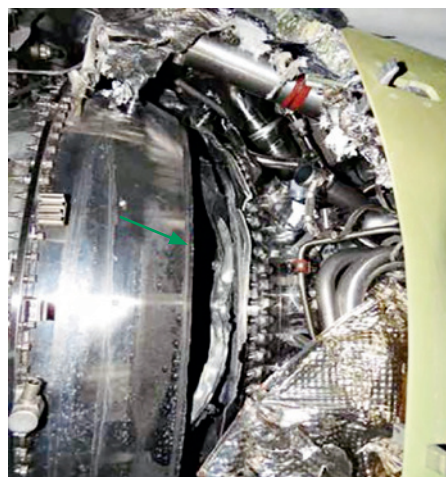
图10 外机匣的撕裂裂缝
