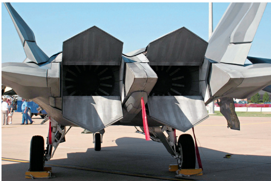
图1 F-22的矩形二维推力矢量喷管
