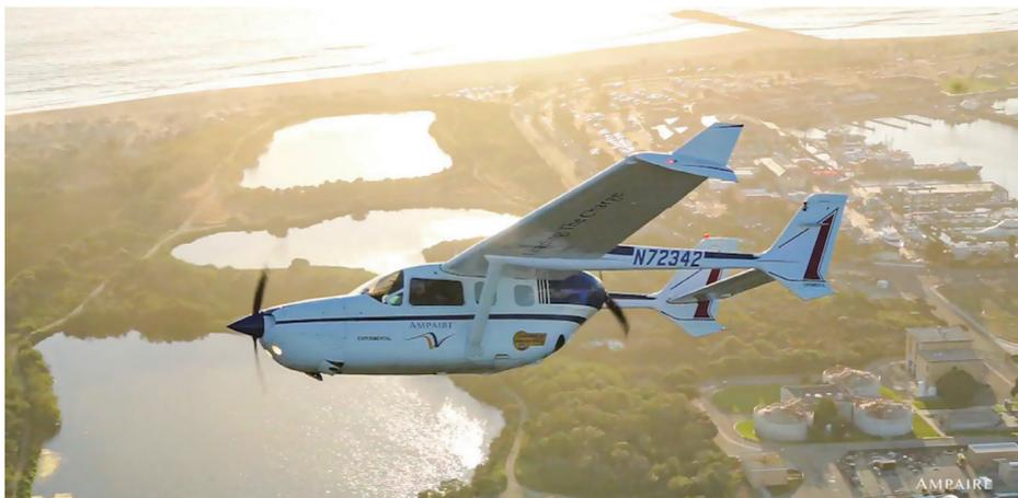
Ampaire公司已经把2架赛斯纳337“空中霸主”改装成混合电推进系统试车台
