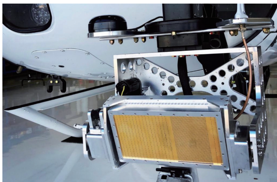
安装在AS350直升机上进行飞行测试的RDR-84K雷达系统
