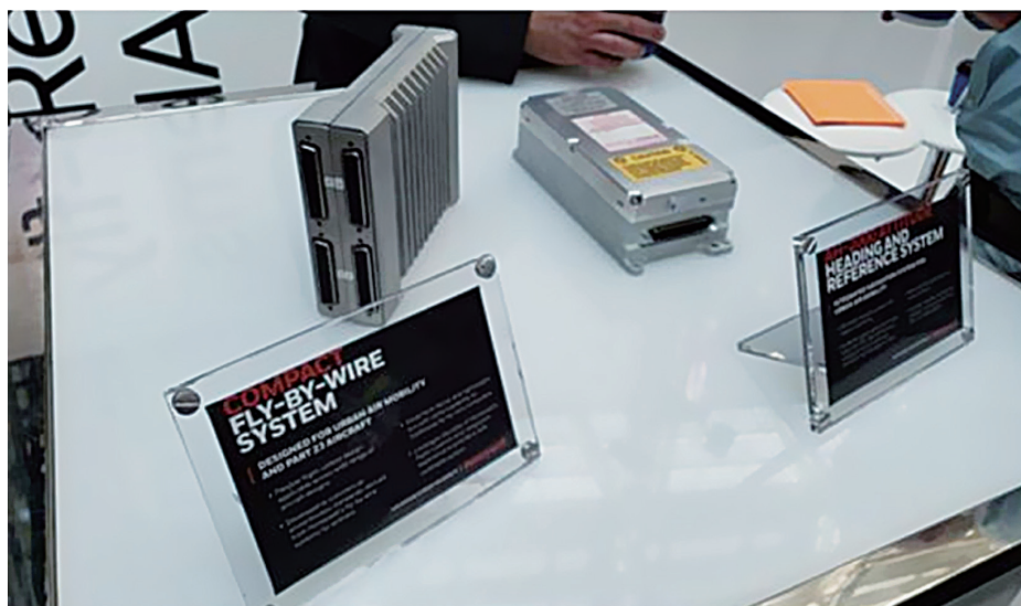
为eVTOL飞行器定制的电传操纵系统（左）和姿态航向参考系统（右）
