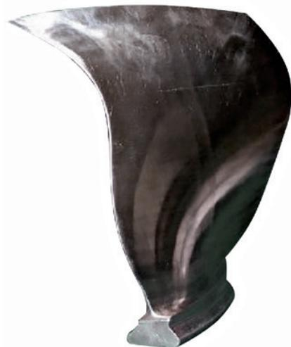
图9 S形跨声速压气机叶片
