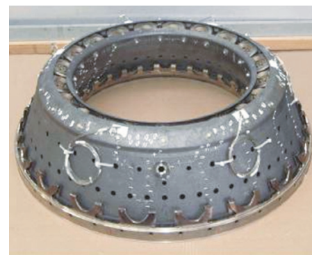
图8 碳化硅陶瓷基复合材料火焰筒
