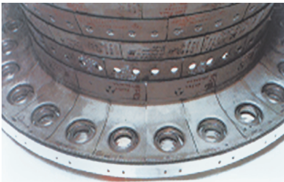
图3 F119发动机燃烧室浮壁式火焰筒
