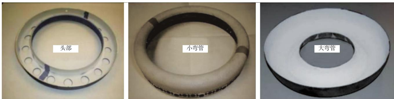
图6 陶瓷基火焰筒零件
