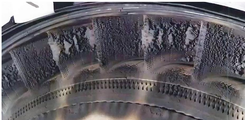
图3 火山灰堵塞涡轮叶片冷却通道
