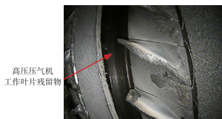
图8 高压压气机转子中仅剩有残留的叶根
