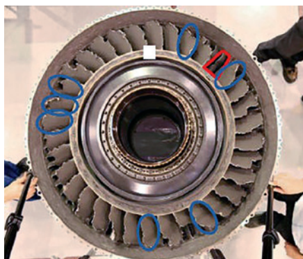
△ 丢失的叶片 ○ 叶根开裂的叶片
