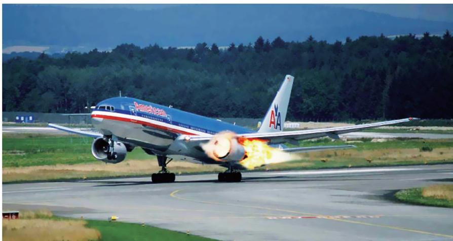
图2 因压气机旋转失速导致发动机着火事故
