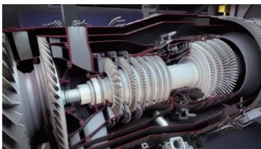
图6 GE公司下一代自适应发动机核心机和分流结构
