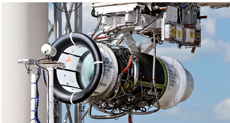
Passport发动机在地面试车台上接受测试
