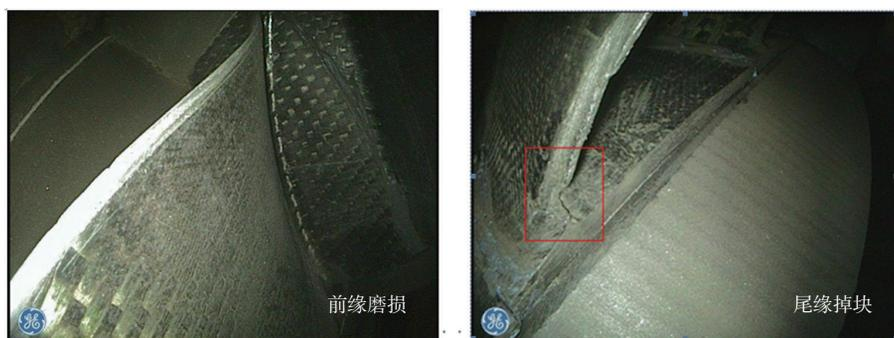
图5 耐冲刷试验50h后损伤形貌
