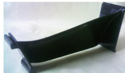
图2 成形的复合材料整流叶片结构工艺件
