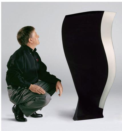
图1 GE90-115B发动机风扇叶片
