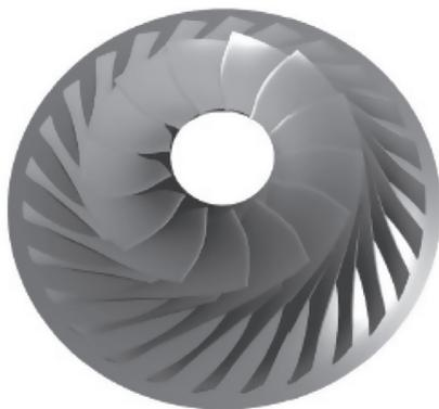
图6 DLR反方法设计叶轮
