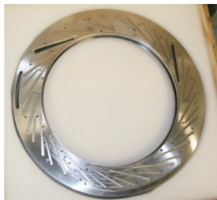
图8 高效率离心压气机楔形扩压器
