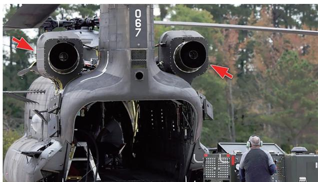
图8 CH-47F直升机换装两台T408发动机（短舱由圆转方）
