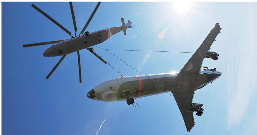
图1 米-26吊运图-134客机机体
