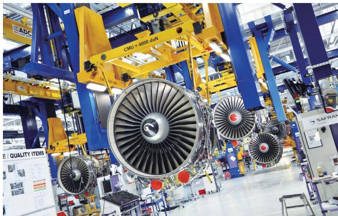
图2 CFM56发动机的精益装配线
