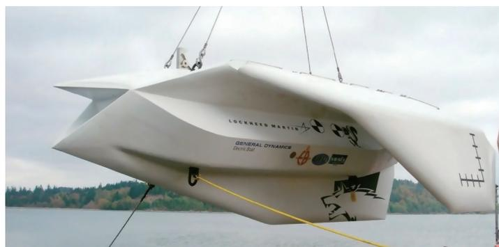
图2 “鸬鹚”潜射无人机
