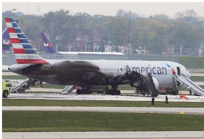
图2 飞机右侧机翼与机身严重烧毁
