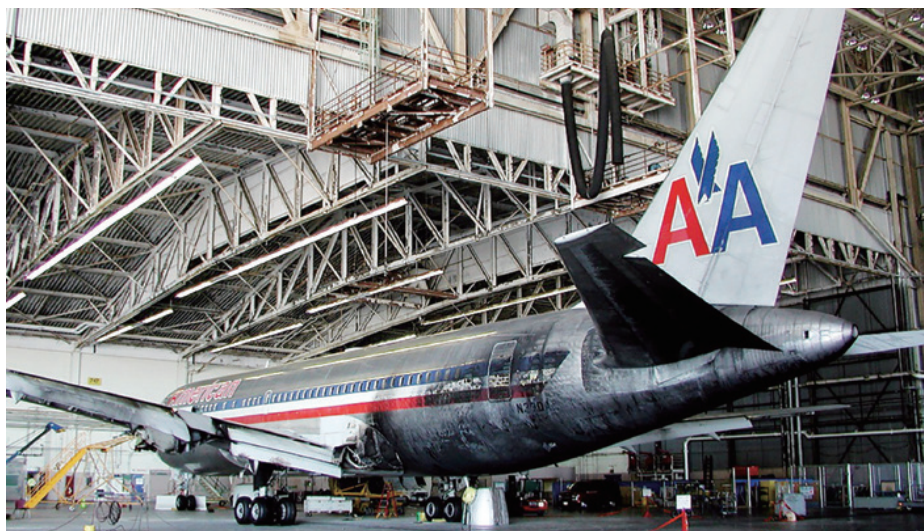
图7 高压涡轮第一级轮盘爆裂引发着火
