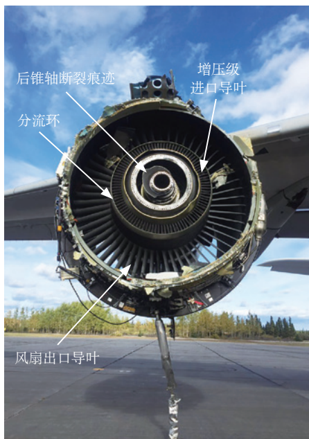
图3 风扇及进气道甩离后的发动机外
