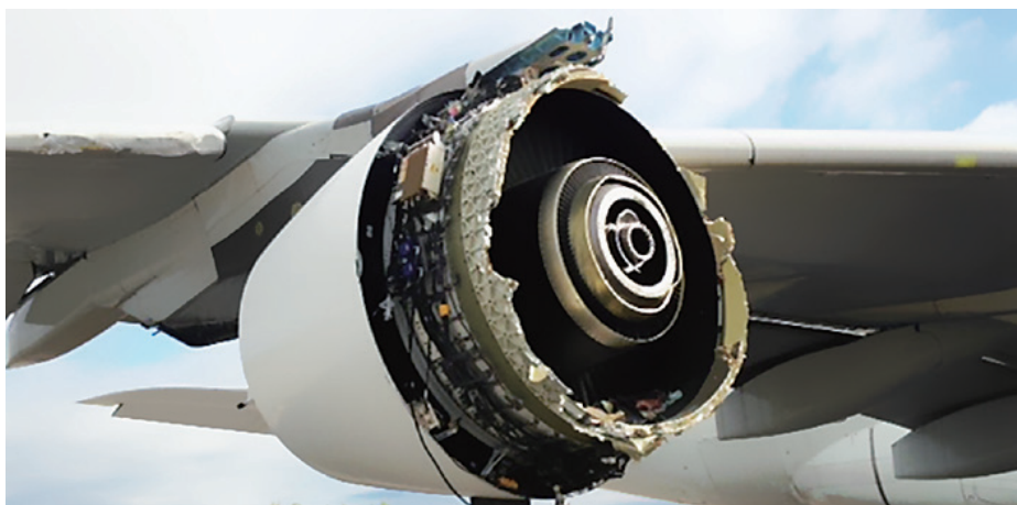
图1 空客A380右外侧发动机损坏情况
