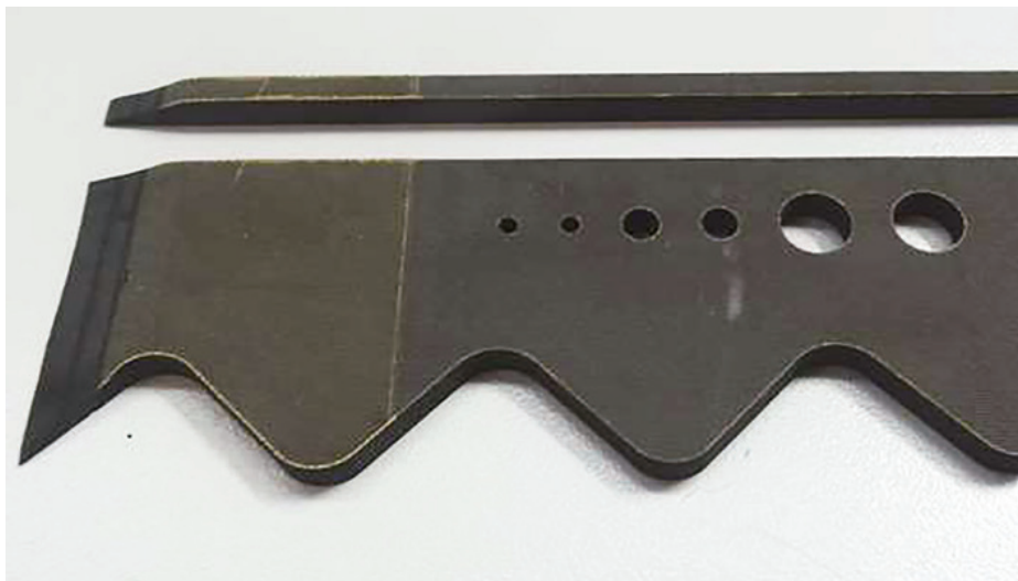
加工后的碳纤维复合材料层板
