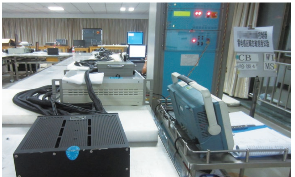
图2 发动机数字电子控制器雷电间接效应试验
