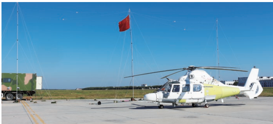
图3 整机HIRF试验外场
