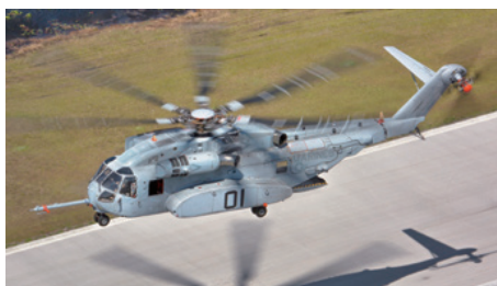
(a) CH-53K 直升机（传统单旋翼带尾桨结构）
