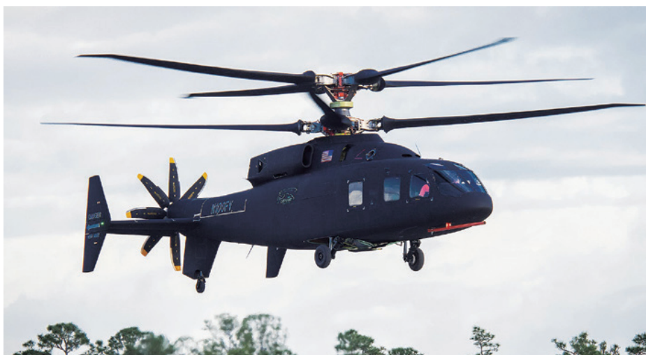
(c) SB-1 直升机（双旋翼带尾部推进器）
