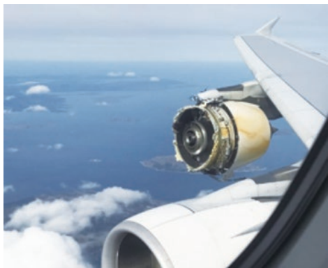
图5 飞行中的空客A380发动机风扇部分坠落
