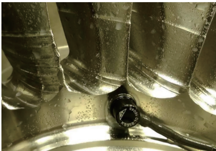
图5 试件局部放置智能传感器
