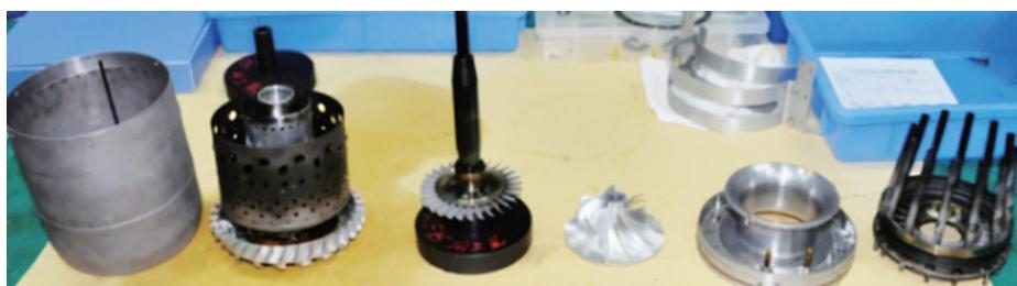
图7 试验后发动机分解图
