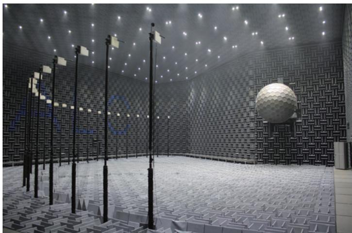
图4 中国航发动力所风扇/增压级声学试验器 (AALC)
