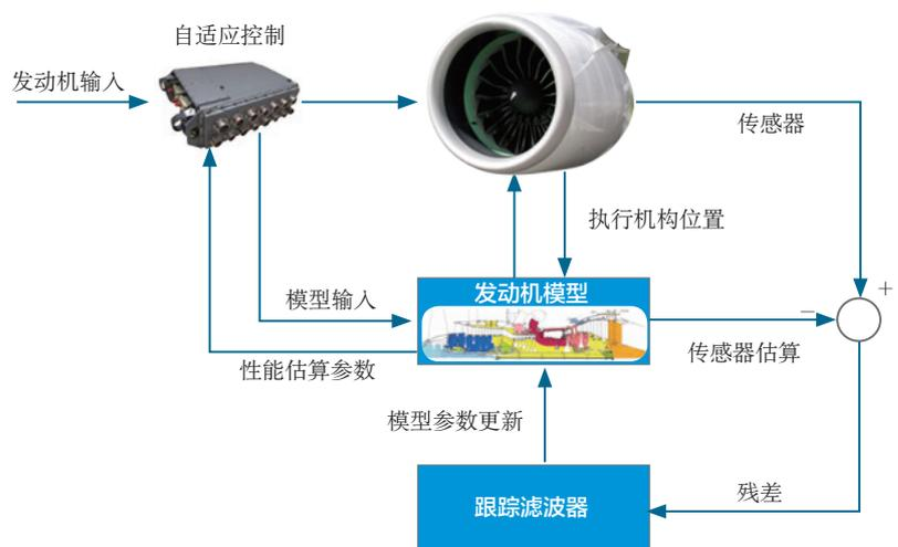
图2 GE公司基于模型的自适应控制概念
