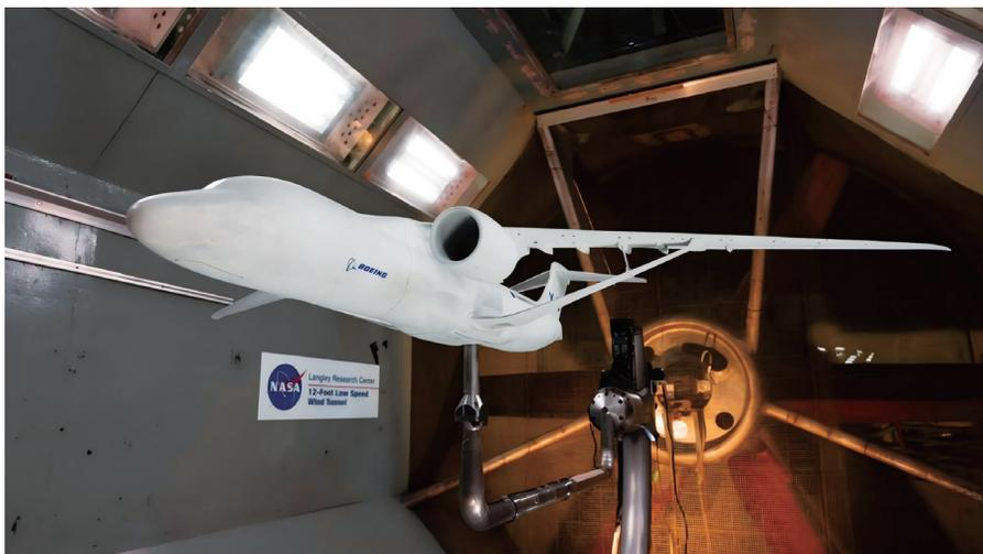
正进行风洞试验的X-66验证机缩比模型
