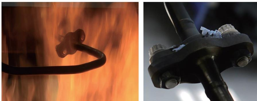
图2 管路防火试验示意
