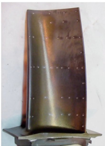
图3 安装微型晶体测量表面温度的涡轮叶片
