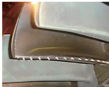
图4 安装微型晶体测量气流温度的涡轮叶片
