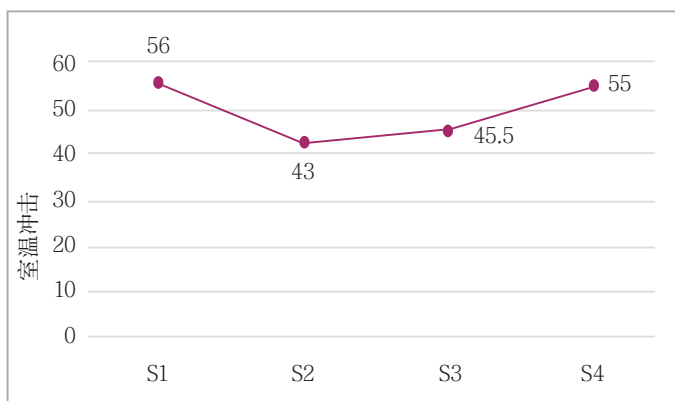
(a) 4组热处理叶片的室温冲击性能
