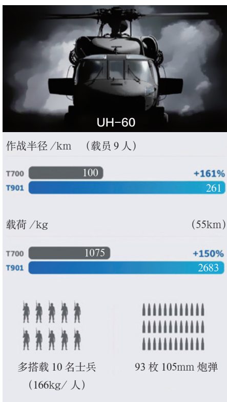
UH-60和AH-64采用T700和T901的性能对比 (高度2743.2m、温度35°C)
