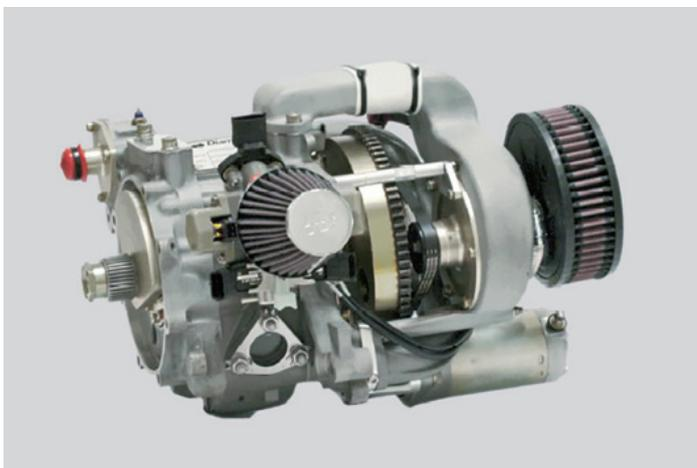
Austro发动机公司研发的 AE50R转子发动机
