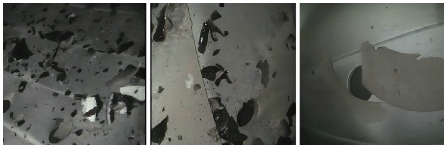
图4 VIPR项目框架下喷撒火山灰后燃烧室零件上的沉积物
