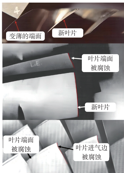
图1 F100发动机流道吸入火山灰引起的压气机叶片侵蚀
