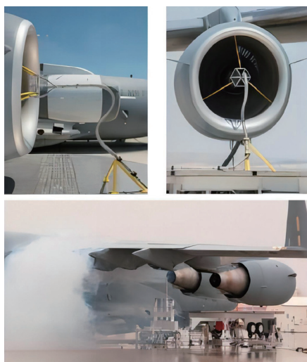
图2 向机翼上的PW2040发动机喷撒火山灰的试验装置
