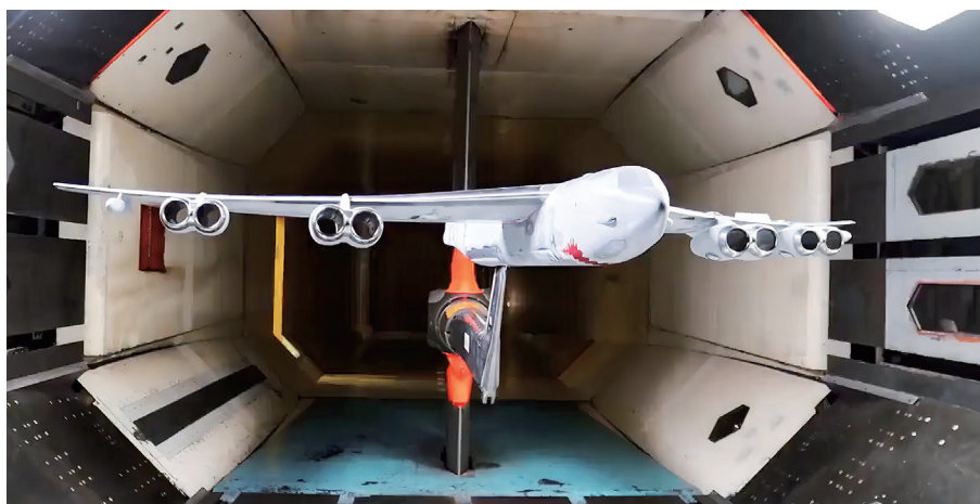
波音公司对换装F130发动机后的B-52轰炸机进行风洞测试
