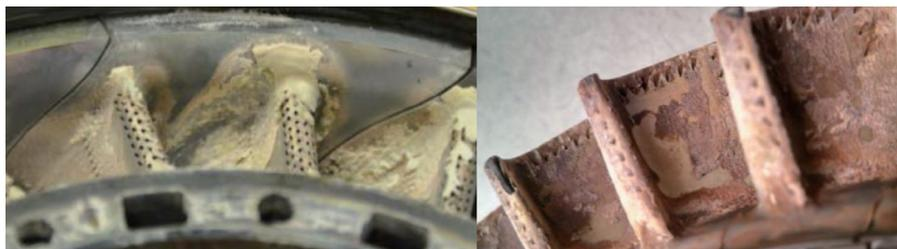
图2 吞砂后的涡轮导向叶片和工作叶片
