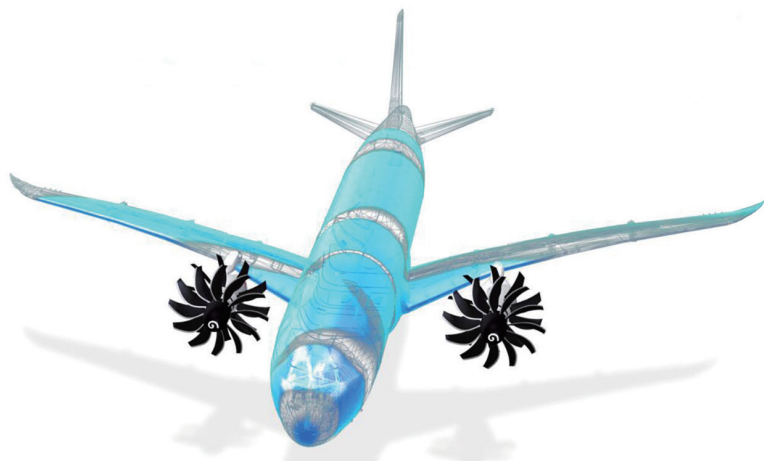
配备开式转子发动机的超高效中短程飞机示意图
