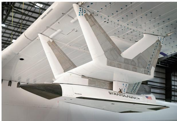
Roc飞机及Talon-A高超声速无人飞行器
