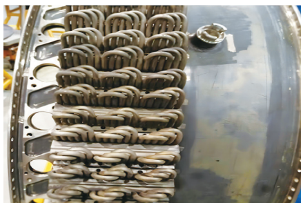
图2 AL-31F发动机的空气—空气换热器
