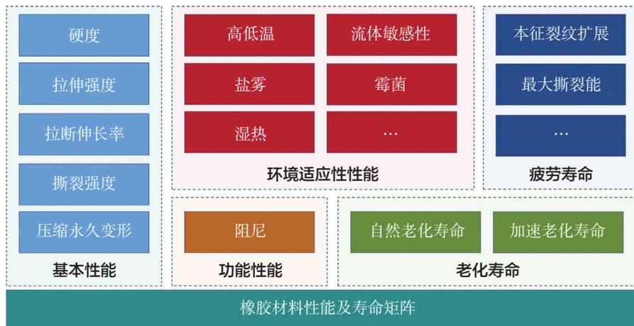
动力装置安装环境适用橡胶材料性能及寿命矩阵
