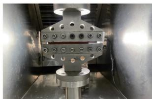
最大撕裂能试验
