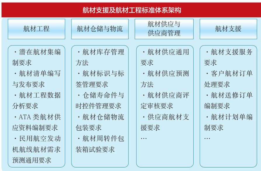
图5 航材支援及航材工程标准体系架构
