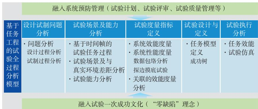
图2 基于任务工程的试验项目分析模型
