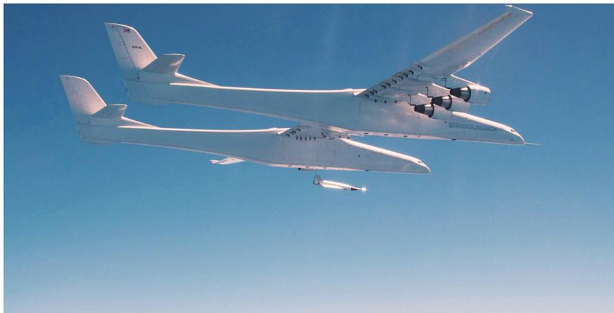
Talon-A高超声速飞行器分离试验
