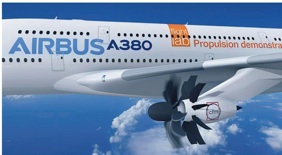
开式转子发动机安装在A380上测试构想
