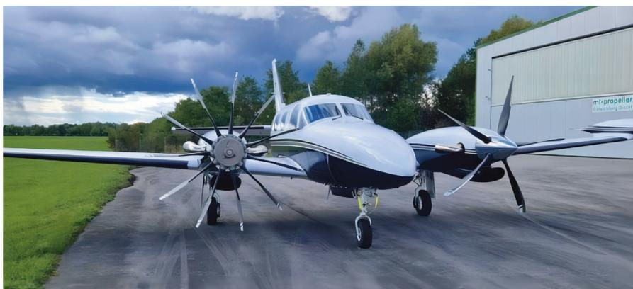
11叶螺旋桨与5叶螺旋桨在飞行试验台上进行对比测试
