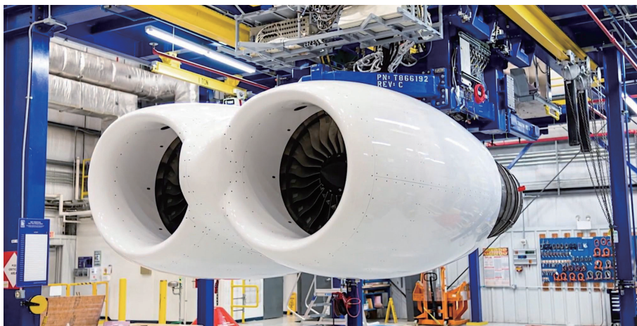
用于B-52轰炸机换发的F130发动机
