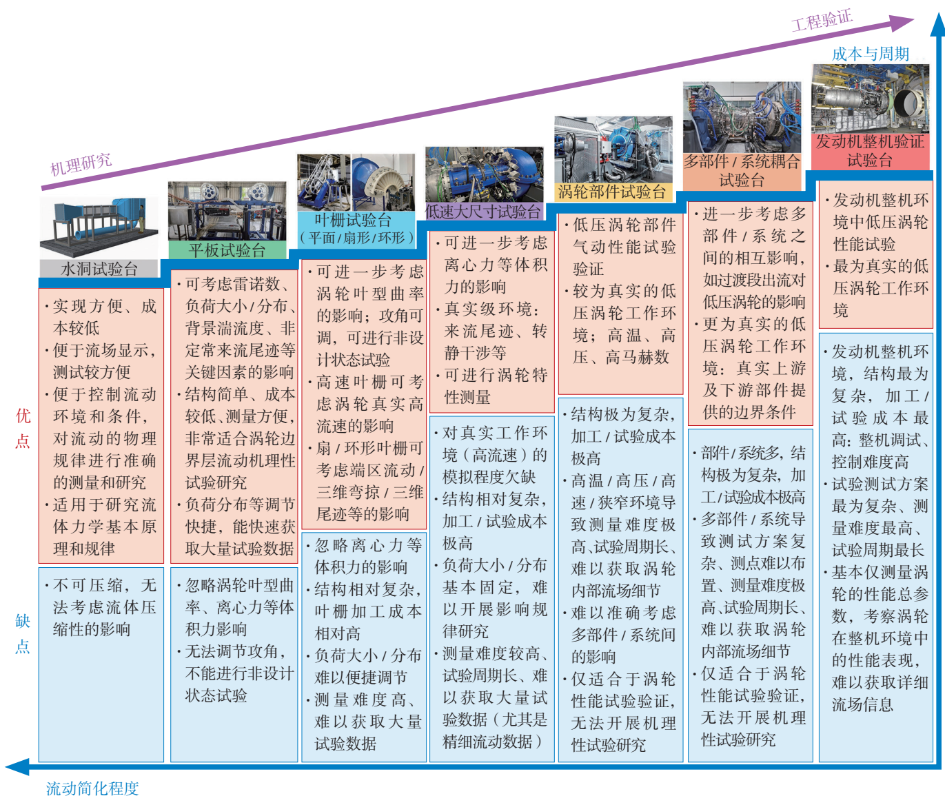
图 1 高负荷低压涡轮多层次试验技术
